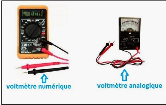
Un voltmètre: appareil d'indication servant à donner l'ordre de grandeur de la tension. Il y a deux types des voltmètres plus utilisés: voltmètre numérique et voltmètre analogique
