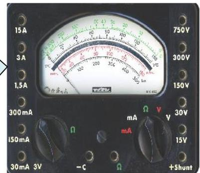
Les multimètres permettent d'effectuer un grand nombre de mesure : tension alternatif ou continu, intensité alternatif ou continu, résistance et encore bien d'autres mesures selon les modèles. Préférez toujours un modèle doté d'un protection interne (fusible) qui évite de détruire l'appareil en cas de mauvaise manipulation.
