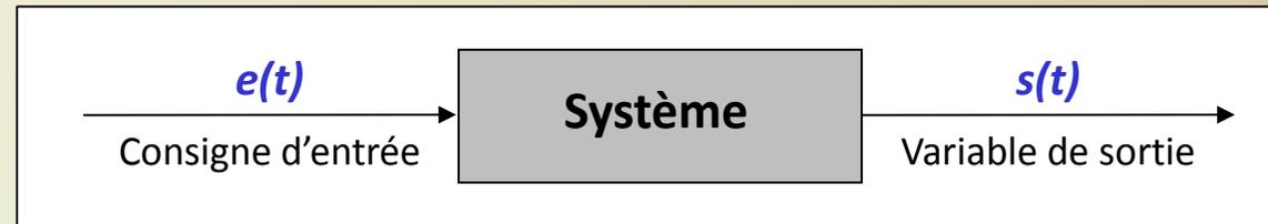
*Un système dynamique, continu, linéaire, invariant, monovariante est décrit par une équation différentielle linéaire, à coefficients constants de la forme suivante :*
