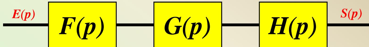
*Lorsque les blocs sont en ligne (en cascade) on a :*
