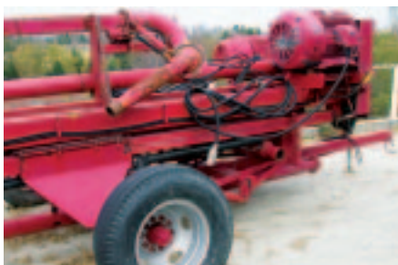
Moteurs de 15 à 50 HP sur une pompe agitatrice de lisier de vache
