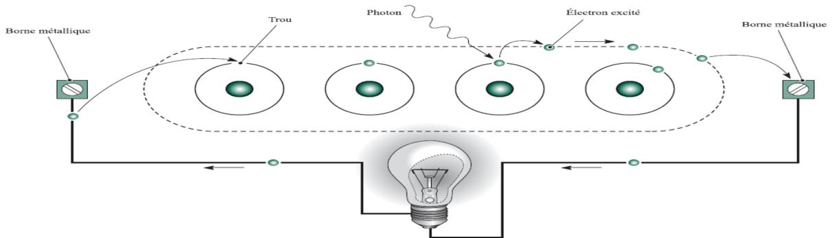
Figure 2 : Description simple de l'Effet Photovoltaïque
