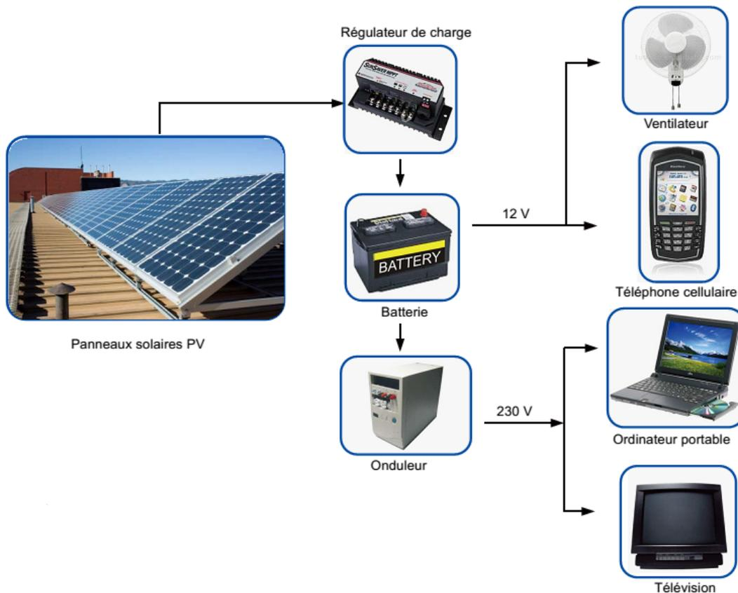
Figure 3 : Représentation d'une installation PV typique.
