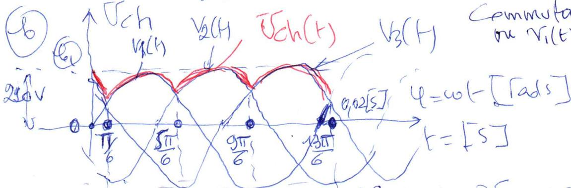
La tension  $V_{ch}$  correspond au maximum de toutes les tensions d'entrées donc c'est la courbe en rouge (Calottes) ou l'enveloppe du signal d'entrée.
