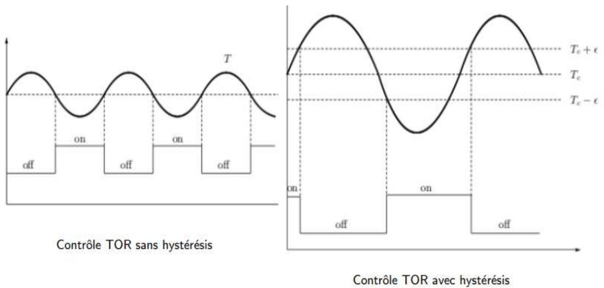
La régulation ON OFF avec hystérésis est une régulation TOR (Tout ou Rien) très utilisée dans la régulation de la température des Fours électrique est chaudières domestique. Le principe est d'essayer de garder la température au voisinage de la consigne c'est-à-dire entre deux valeurs ( $T_{\text{consigne}} - h$ ) et ( $T_{\text{consigne}} + h$ ) avec  $h$  (l'hystérésis) est de quelques degrés de Celsius généralement  $< 10^{\circ} \text{C}$
