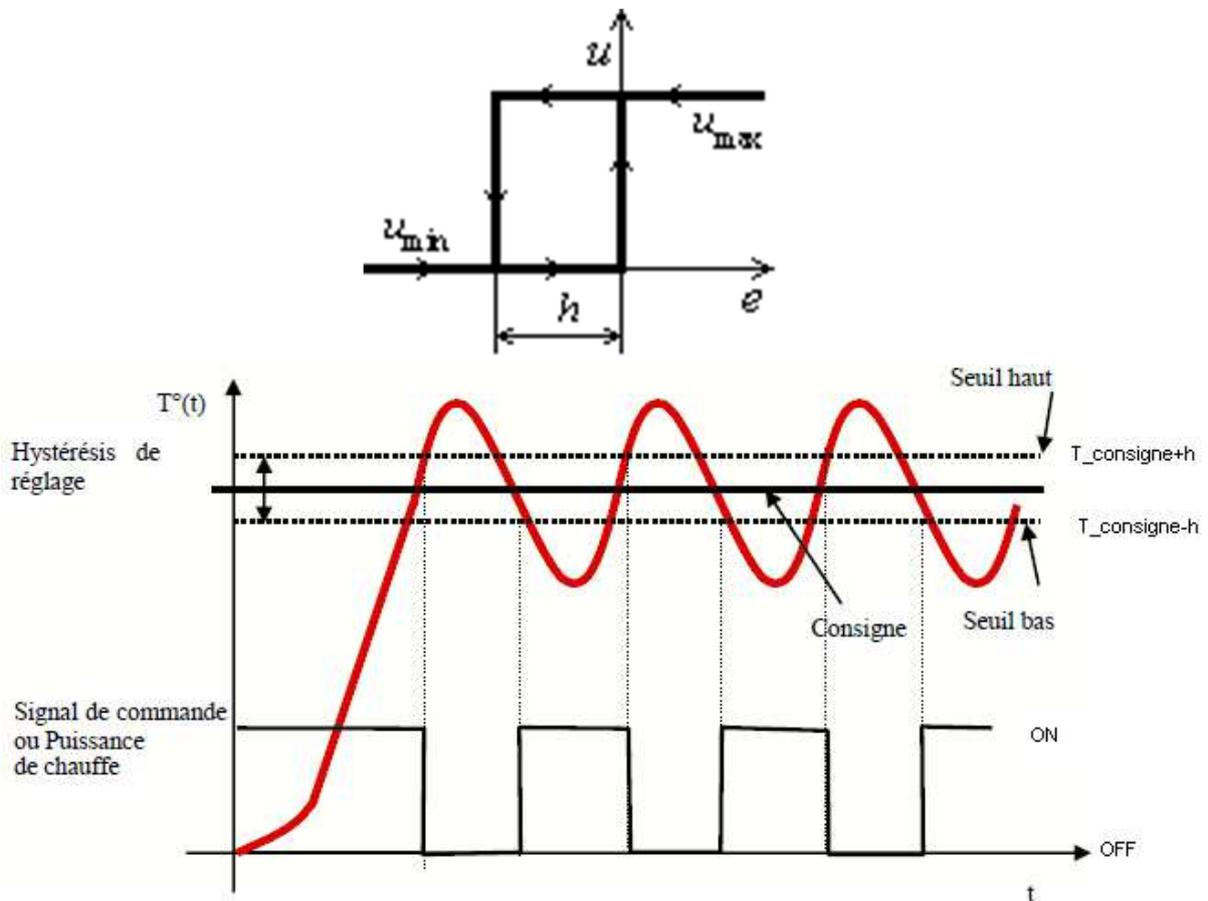
**Nb : on suppose que la résistance chauffante est reliée à travers un relais**
