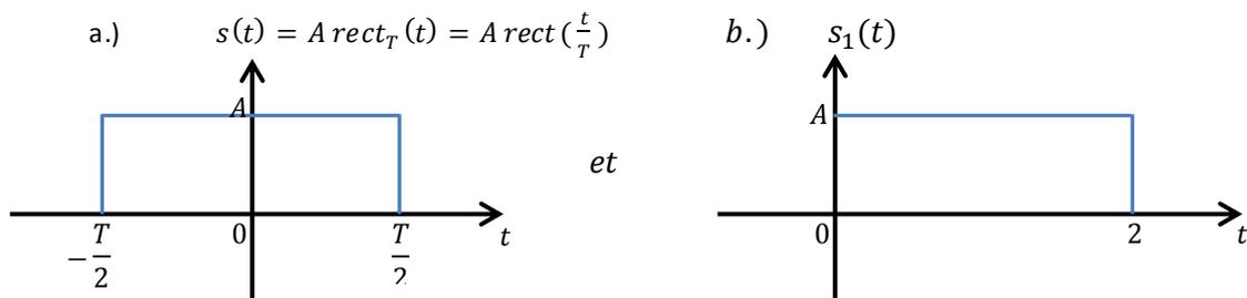
$$s(t) = A \text{rect}_T(t) = A \text{rect}\left(\frac{t}{T}\right) = \begin{cases} A & \text{si } |t| \leq \frac{T}{2} \\ 0 & \text{sinon} \end{cases}; \text{ fen\^etre rectangulaire ou signal porte} \\ \text{d'ouverture (ou largeur) } T \text{ et d'amplitude (ou hauteur) } A$$
