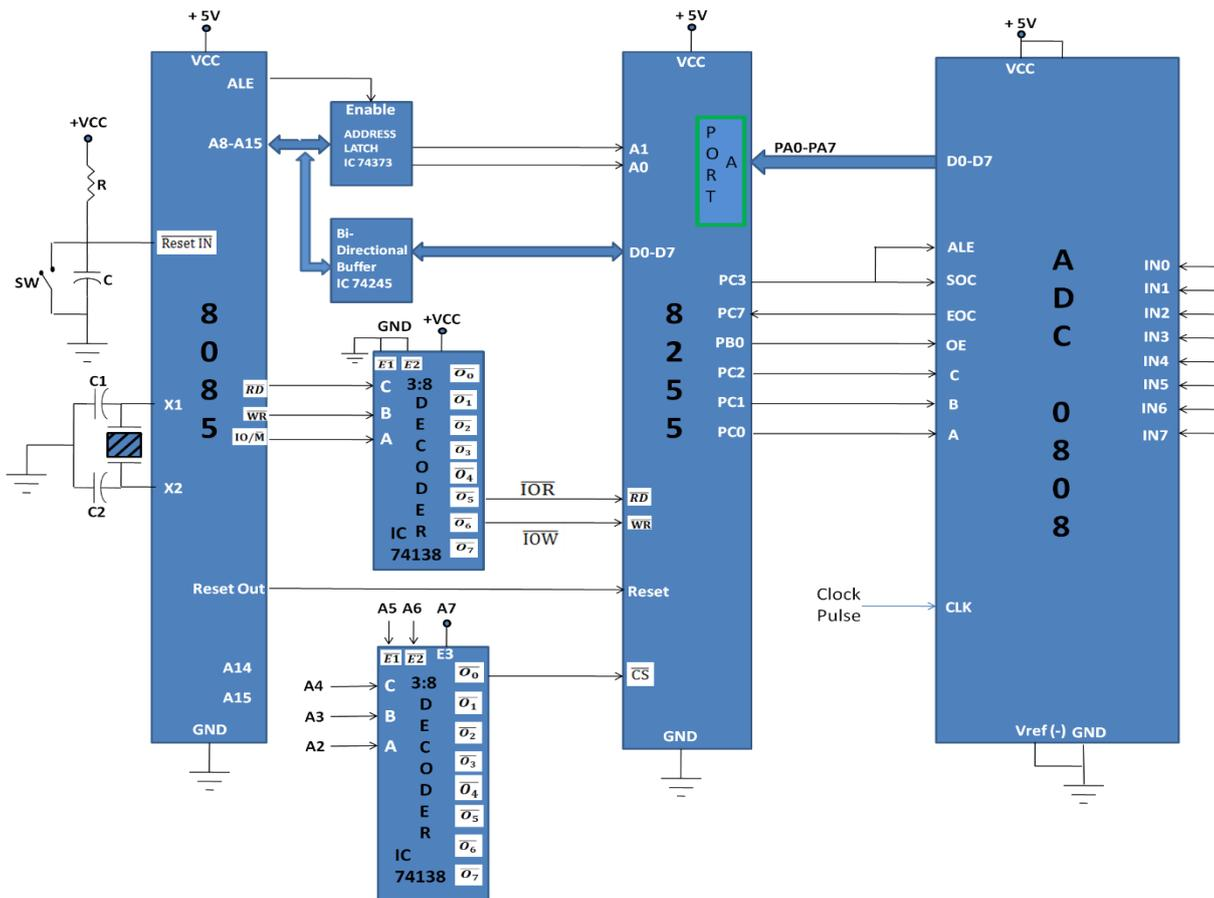
**Objective :** Avoir une notion sur l'acquisition d'un signal analogique avec carte à microprocesseur. Développement d'une interface pour acquisition des signaux analogiques et adaptation des signaux analogiques avec les convertisseurs à 8 bits.
