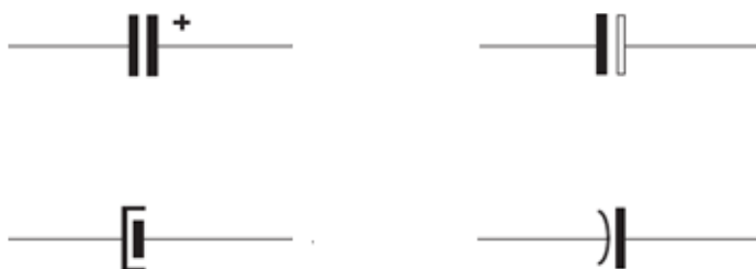
Divers symboles employés pour représenter les condensateurs polarisés
