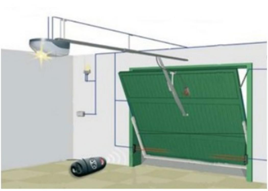
Figure 4. La porte de garage automatisée
