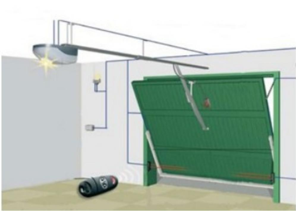
**Figure 4. La porte de garage automatisée**
