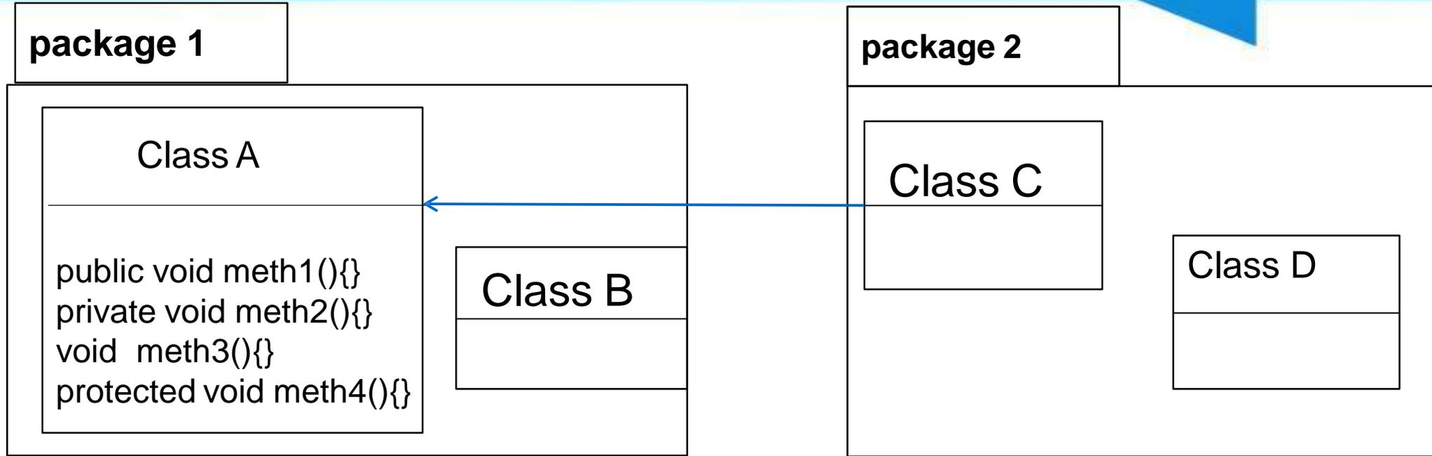
`protected void meth4()` → la méthode protected est accessible que depuis les classes faisant partie du même package et aux sous classes même si elles sont définies dans un package différent
