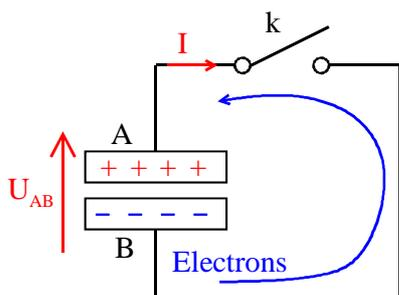
Relions par un conducteur les bornes des armatures A et B du condensateur chargé en fermant l'interrupteur  $k$ . Les électrons accumulés sur l'armature B circulent vers l'armature A où ils neutralisent les charges positives. On dit que le condensateur se décharge.
