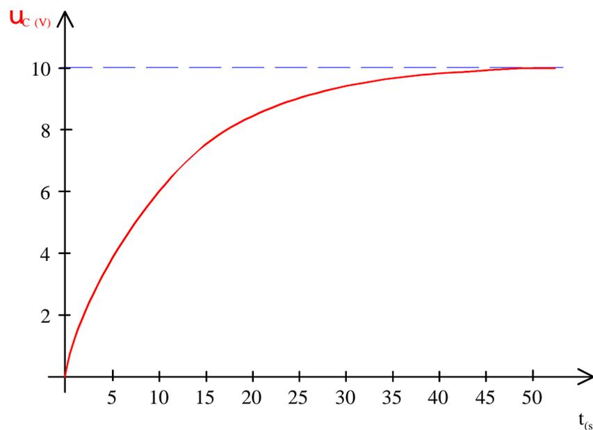
Le condensateur se charge suivant une courbe 'exponentielle'. Au bout d'un certain temps, la tension aux bornes du condensateur ne varie plus, le condensateur est totalement chargé.
