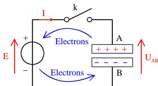
Au départ, le condensateur est totalement déchargé, la tension  $U_{AB}$  à ses bornes est nulle. Fermons l'interrupteur  $k$ . Les électrons circulent de la borne - du générateur vers l'armature B. Ces électrons repoussent ceux de l'armature A qui retournent à la borne + du générateur, laissant ainsi des trous (absence d'électrons) ayant une charge positive. On dit que le condensateur se charge.
