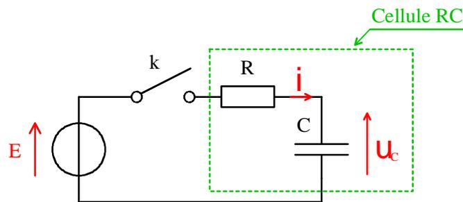
A la mise sous tension du dispositif, le condensateur est totalement déchargé, la tension à ses bornes vaut  $U_C = 0\text{V}$ .
