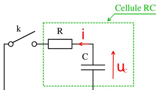
Au départ (à l'instant  $t = 0$ ), le condensateur est chargé. La tension à ses bornes vaut  $U_C = 10V$ . On ferme l'interrupteur  $k$ . Le condensateur se décharge à travers la résistance  $R$  suivant une courbe exponentielle.
