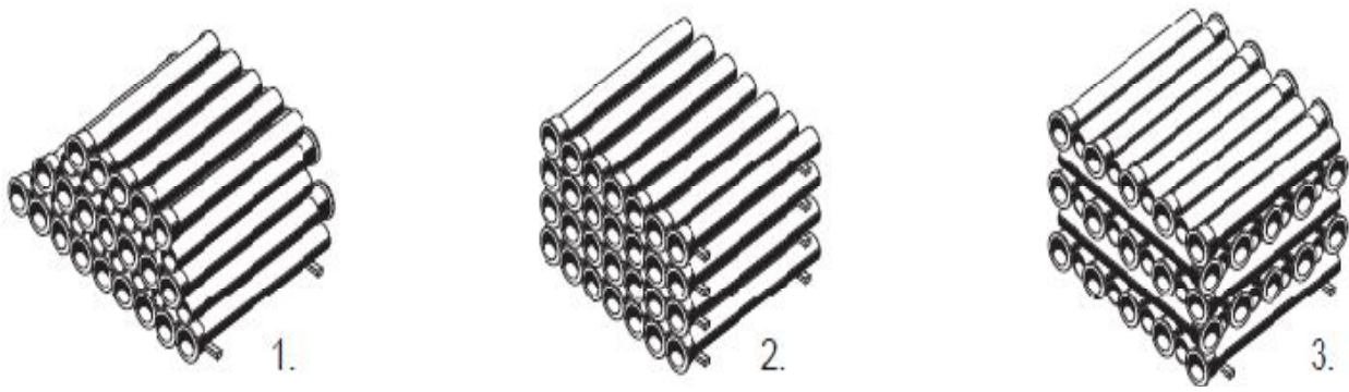
Figure II.10 : Méthodes de stockage des tuyaux (Hamdane, 2014)
