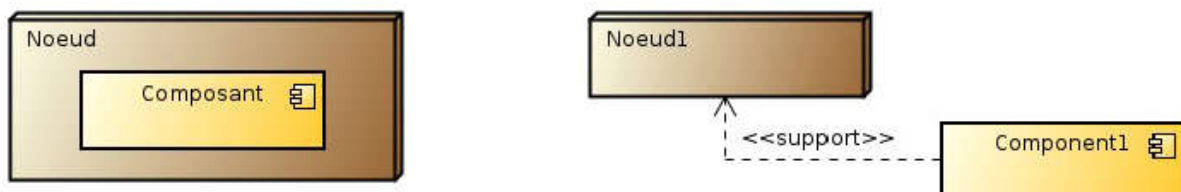
Figure 8 Représentation d'un composant affecté sur un noeud.
