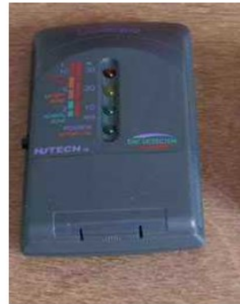
Détecteur de champ magnétique. Hutech EMF detector Seuil de detection : 2 mG
