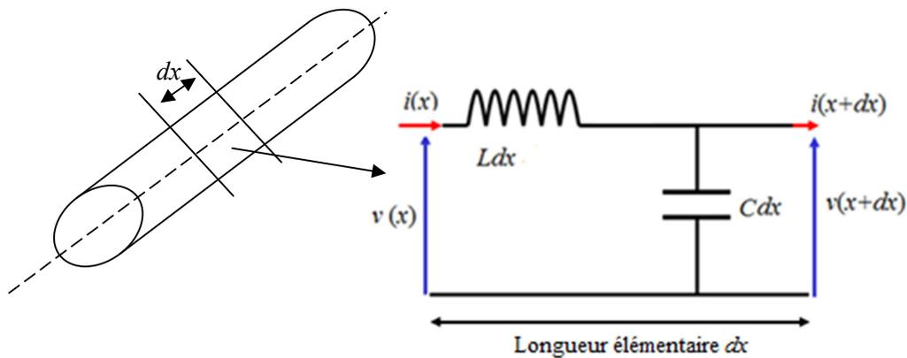
**Figure 1.5 :** Schéma équivalent d'un tronçon de ligne sans perte
