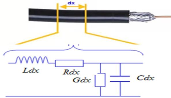
**Figure 1.4 :** Schéma équivalent d'un tronçon de ligne
