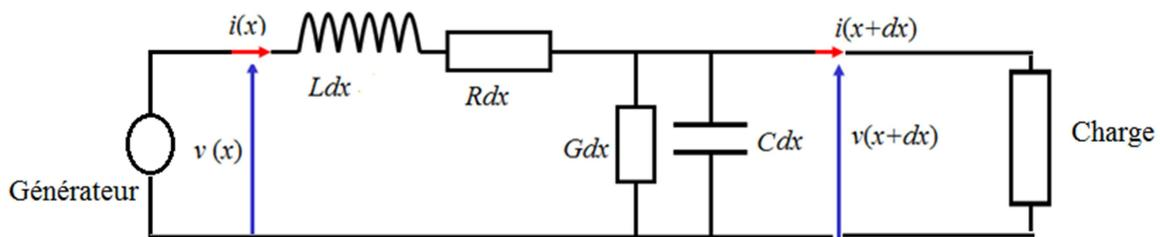
**Figure 1.6 :** Modèle réel d'une ligne de transmission électrique.
