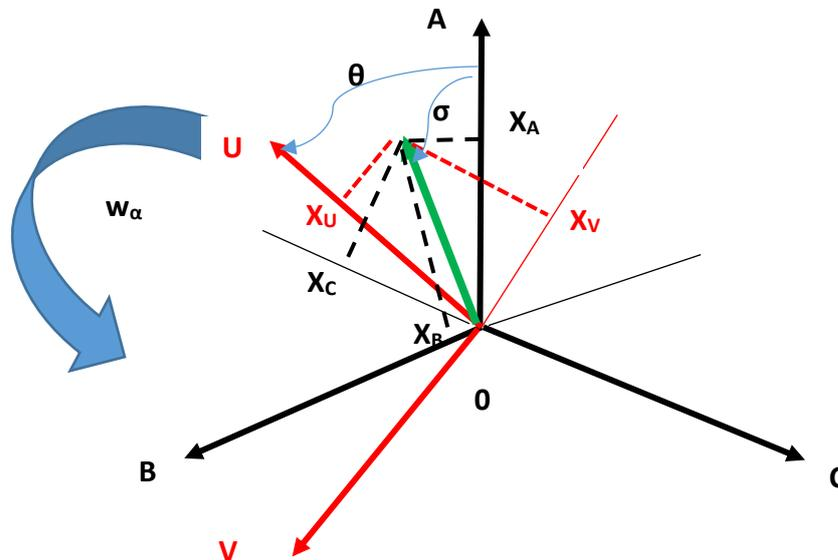
Où, système d'axe triphasé ABC et système d'axe biphasé (U, V)
