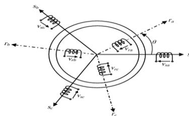
Fig. 2.1 Représentation d'une machine électrique généralisée triphasée
