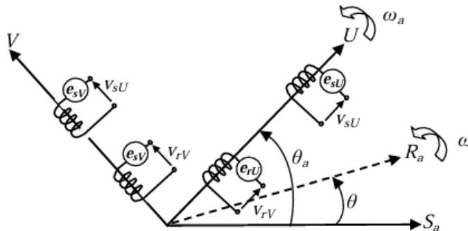
Fig.2.3 : Modèle généralisée biphasé selon les axes UV
