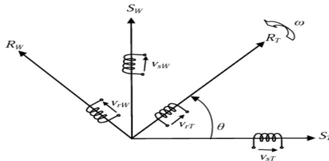
Fig. 2.2 Représentation d'une machine électrique biphasée généralisée
