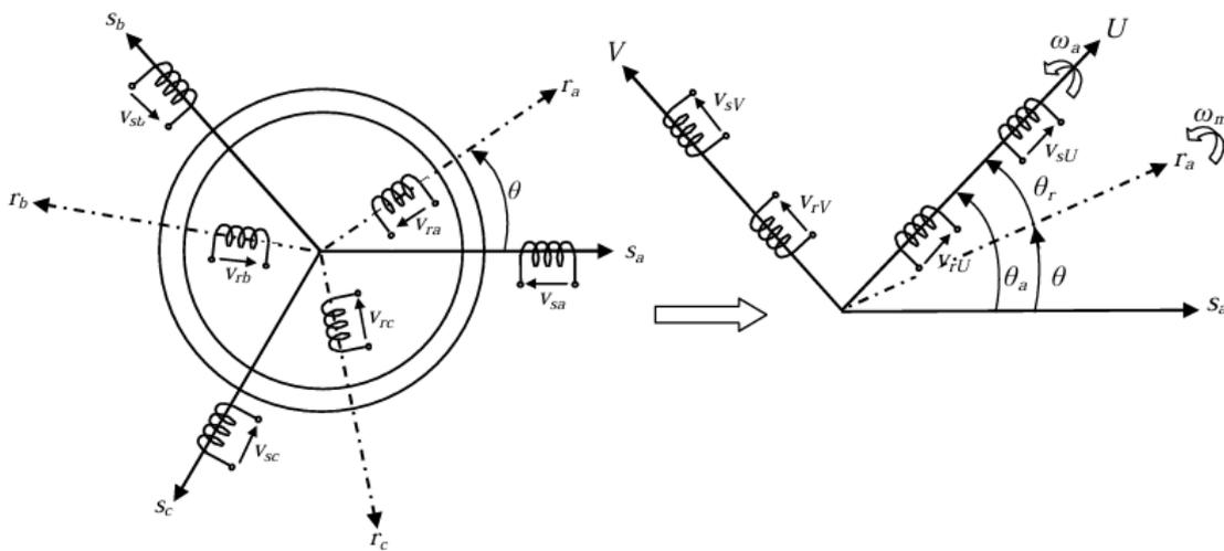
Fig. 2.4 : Passage du système triphasé abc au système biphasé UV
