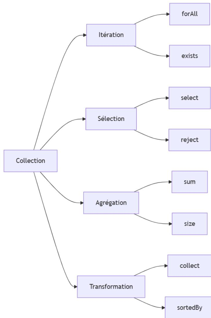
Figure 4 diagramme résumant les opérations de collecte OCL courantes.
