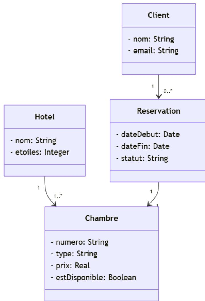
Figure 6 Diagramme de classes pour un système de réservation d'hôtel.
