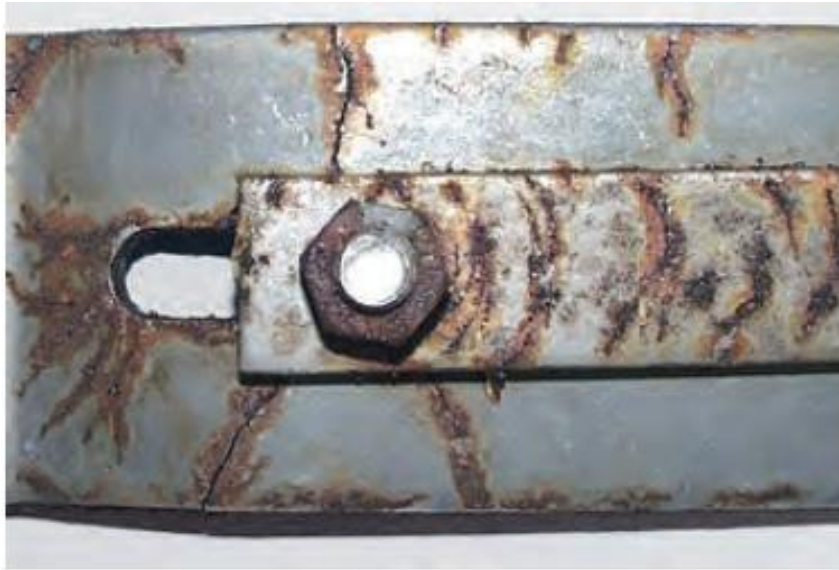
Corrosion sous contrainte d'un acier inoxydable
