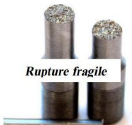
Faciès de rupture d'une éprouvette de Charpy rompue à -70 °C.
