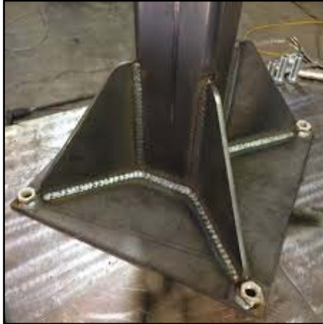
Figure 19 : Soudure de la base d'un poteau
