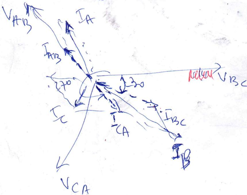
**Exemple 4.** Un réseau triphasé à trois conducteurs de 240 V (ABC) alimente une charge montée en triangle et comportant les impédances  $Z_{AB} = 10/0^\circ \Omega$ ,  $Z_{BC} = 10/30^\circ \Omega$  et  $Z_{CA} = 15/-30^\circ \Omega$ . Calculer les trois courants de ligne et tracer le diagramme vectoriel du système.
