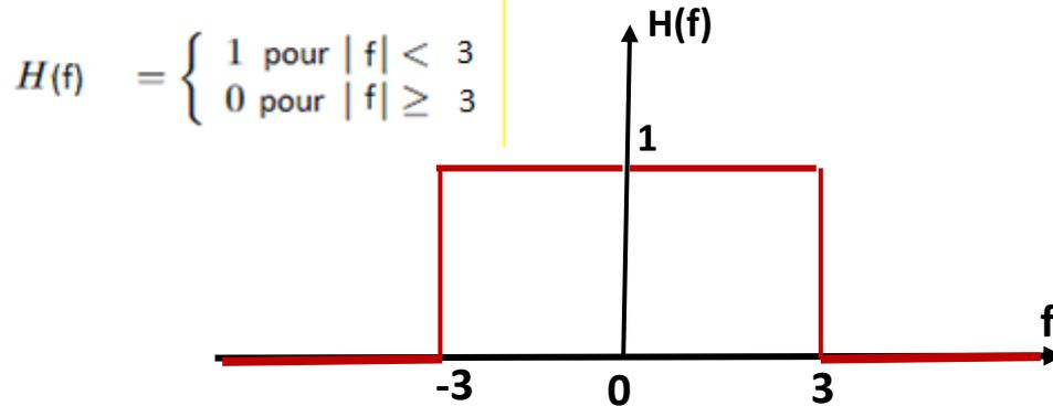
b)- Il s'agit d'un filtre passe-bas idéal qui laisse passer que les fréquences comprises entre 0 et 3
