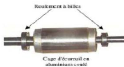
rotor d'une machine asynchrone
