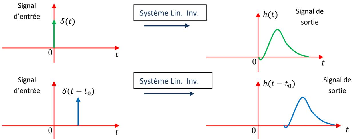
En écrivant tout signal d'entrée  $x(t)$  sous forme d'une fonction intégrale de l'impulsion de Dirac, Sachant que
