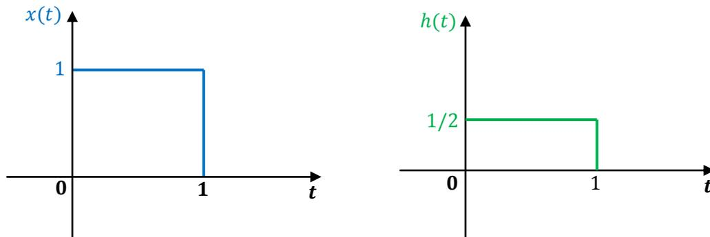
Pour évaluer l'intégrale de convolution de ces deux signaux on effectue les étapes suivantes en utilisant une technique graphique (convolution de 2 signaux portes) :
