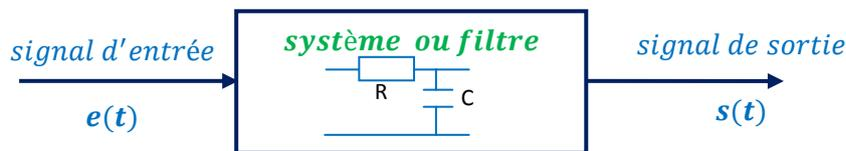
Un système est toujours décrit par la relation entrée/sortie évoluant dans le domaine temporel ou fréquentiel.
