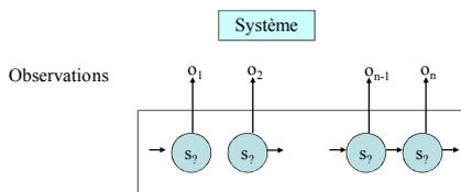
On veut trouver la séquence d'états  $I = s_{i(1)}, \dots, s_{i(n)}$  qui a la probabilité maximale d'avoir généré  $O = o_1, \dots, o_n$  ?
