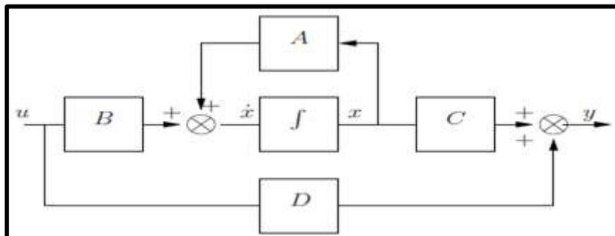
Fig 2 . Schéma-bloc d'une représentation d'état
