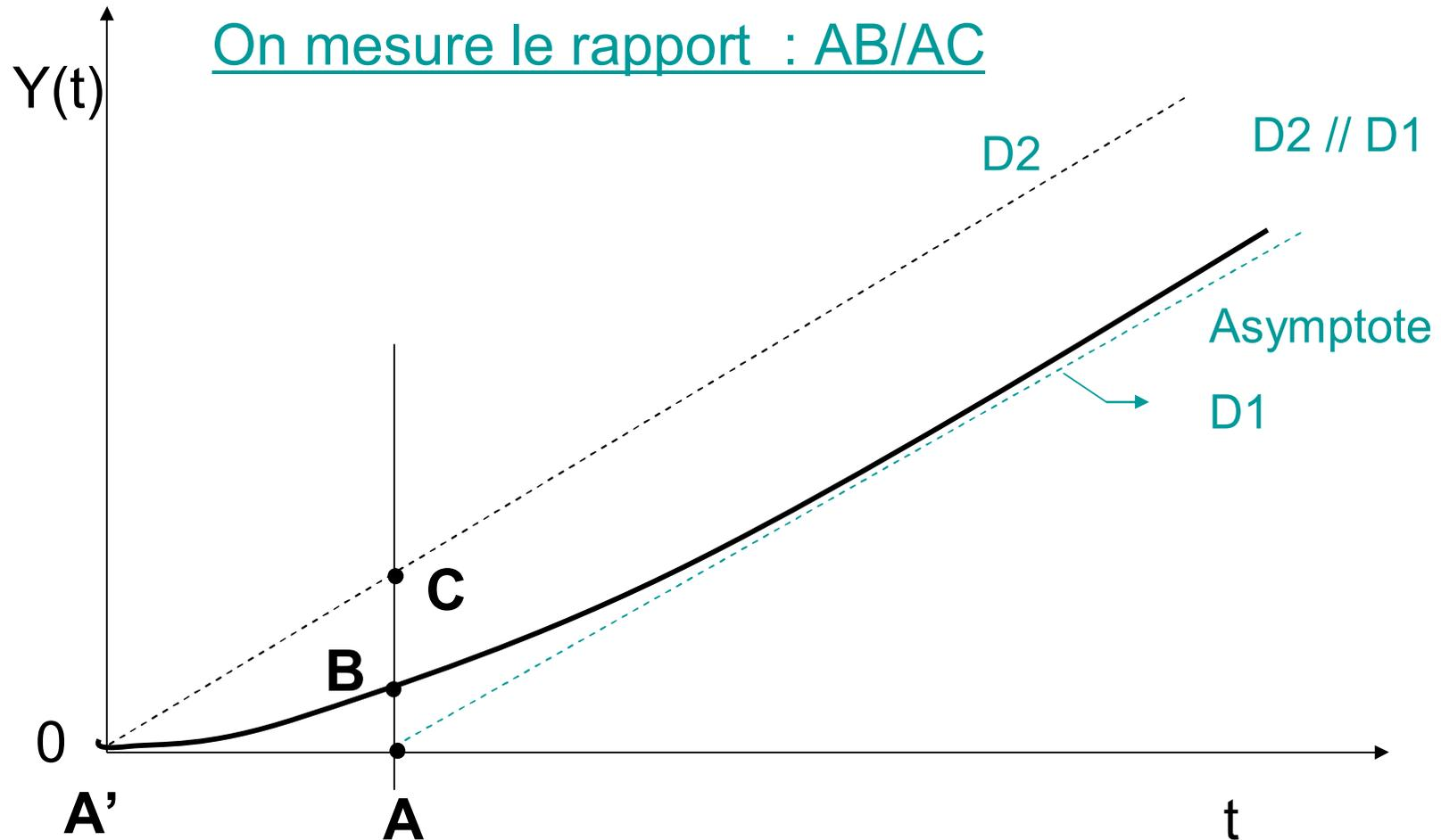
Ce rapport permet de déterminer  $n$  (figure ), voir TD .
