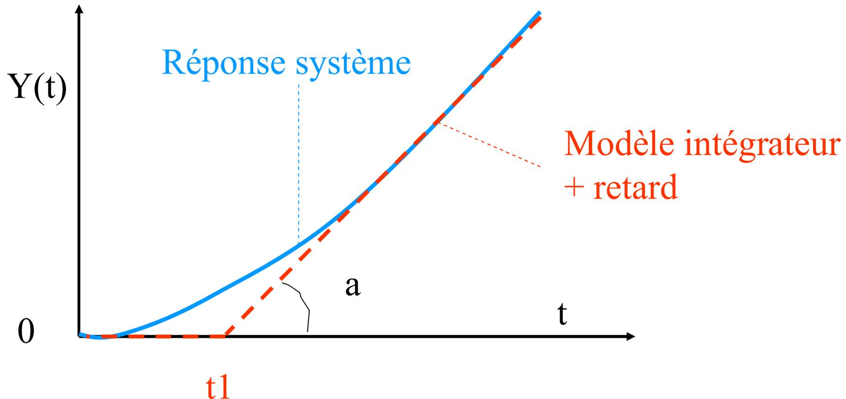
On identifie la réponse du système réel à la réponse d'un système intégrateur pur avec retard c'est-à-dire de fonction de transfert :
