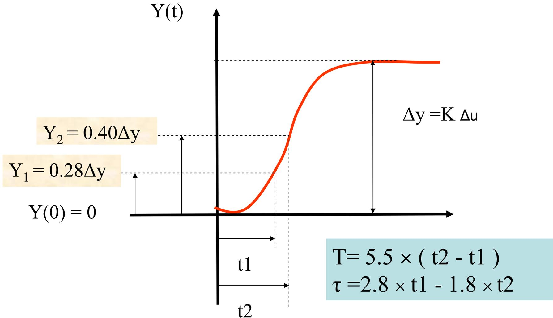
Le modèle de Broïda donne un modèle correct si  $T > 4.\tau$
