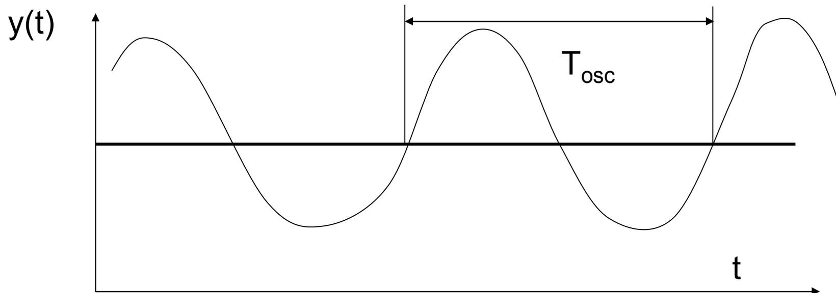
Lorsque le procédé asservi fonctionne en régime harmonique, le gain  $K_R$  est appelé gain critique du régulateur  $K_{RC}$  et la période d'oscillations est  $T_{osc}$ .
