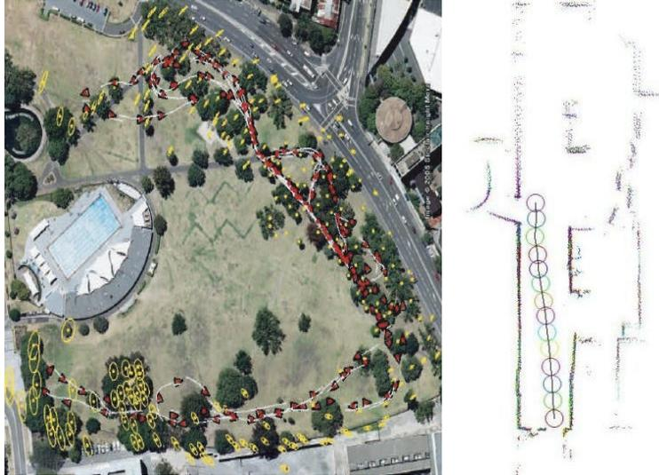
FIGURE 9.3 – Exemples de cartes métriques à base de points isolés (on parle alors d'amers, à gauche, repris de [109]) et de carte à base de scans lasers (chaque cercle est le centre d'un scan laser regroupant les points de la même couleur, à droite).
