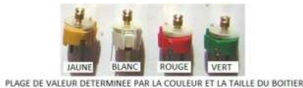
Figure 8 : Code couleur des condensateurs ajustables
