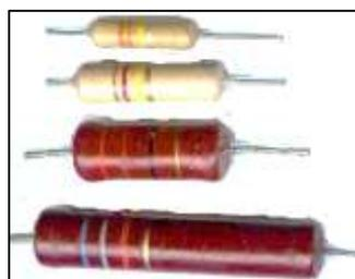
Figure 5 : résistance de différentes puissances
