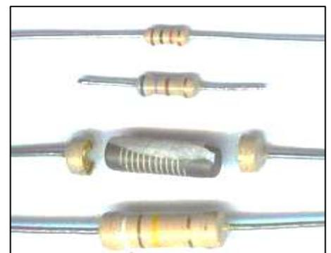
Figure 4 : résistance en couche de carbone
